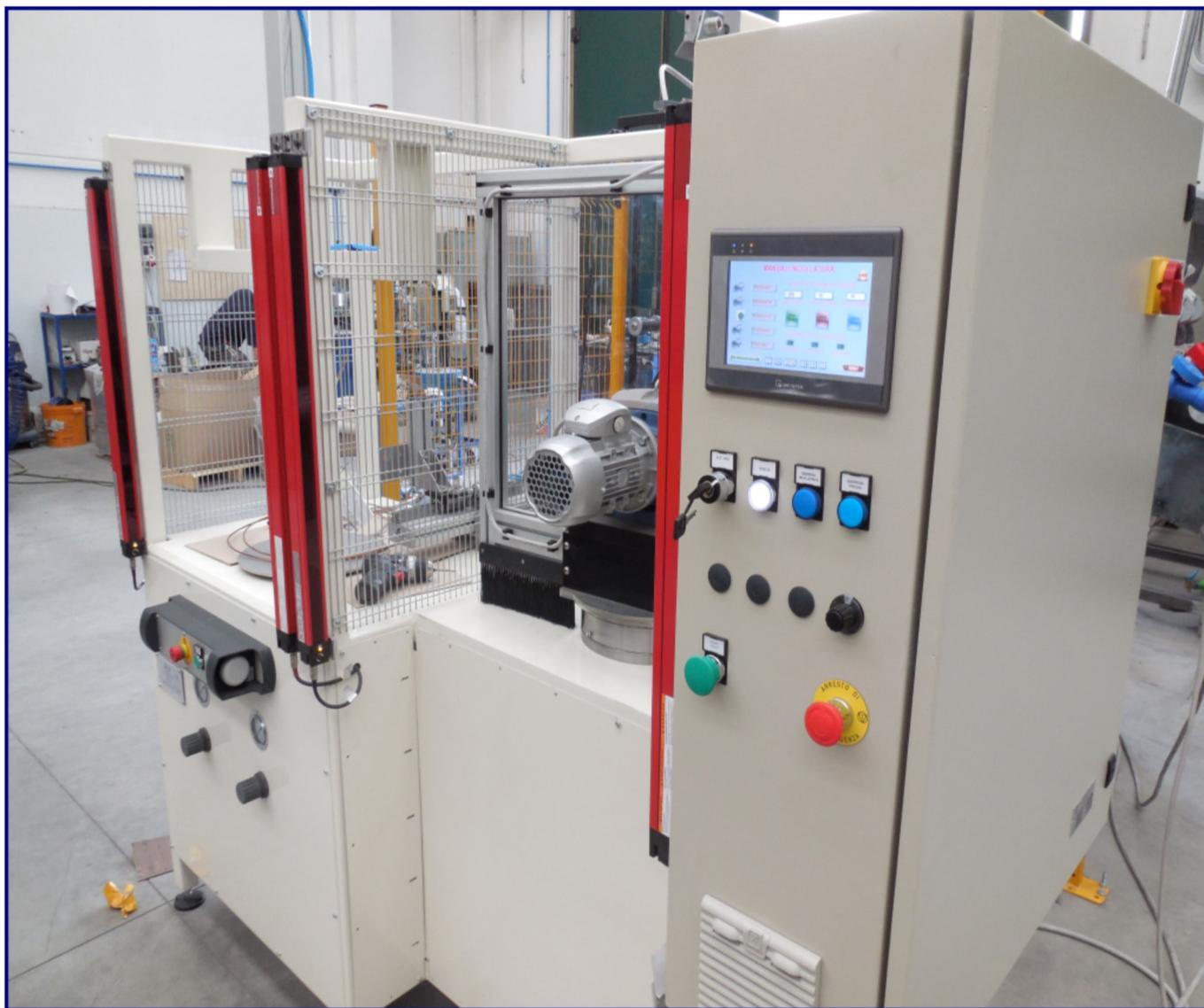
Questo impianto compatto è stato realizzato per la pressatura, la resinatura e la centrifuga della ruota. Il sistema è comandato da un PLC multifunzione con pannello operatore che gestisce tutti i processi di lavorazione. La macchina è divisa in due postazioni: incollaggio/pressatura e centrifuga ruote.
